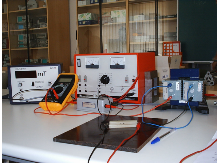
Figura 4: Imagen real del circuito utilizado para medir el ciclo de histéresis punto a punto con un circuito y un teslámetro.
