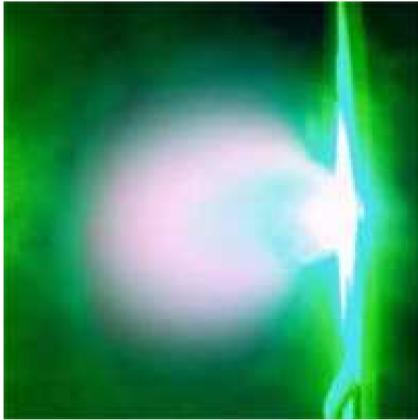
Figura 7: Pluma de un láser usado para ablación.
